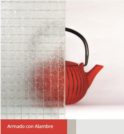
Vidrio translúcido al cual se ha incorporado durante su fabricación una malla de alambre de acero, con una trama de 12 x 12 mm que, en caso de rotura, actúa como soporte temporario del paño de vidrio, evitando la caída de fragmentos de vidrio.
